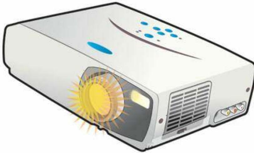
La tecnologia DLP (Digital Light Processing), anche chiamata DMD (Digital Micromirror Device), è basata sul principio della riflessione. Il segnale digitale è interpretato come un comando rivolto a dei micro-specchi che rifletteranno o no la luce derivante dalla lampada del proiettore.
